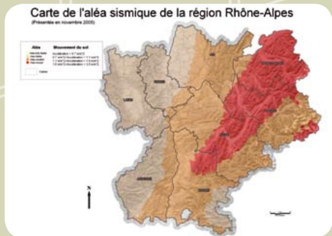
En Rhône-Alpes, le nouveau zonage de l'aléa sismique a permis de mettre en évidence une augmentation significative du risque relatif dans les Alpes. Par conséquent, la DIREN Rhône-Alpes conduit des actions spécifiques dans le cadre d'un Plan Séisme régional : sensibilisation du public et des collectivités sur les règles de construction sismiques
